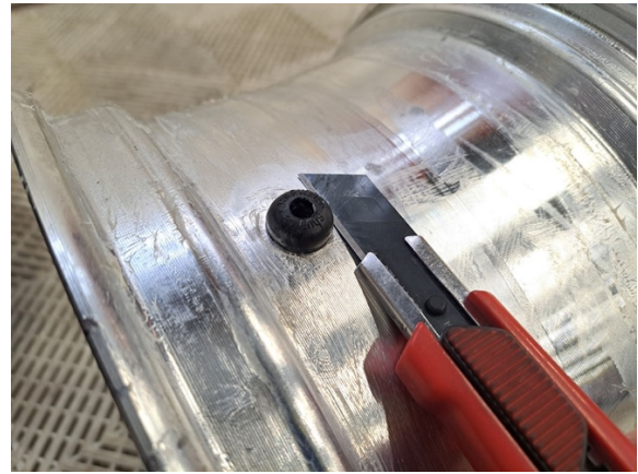
Leikkaa vanha venttiilin kanta pois ja ota venttiili pois. (mattoveitsi).
