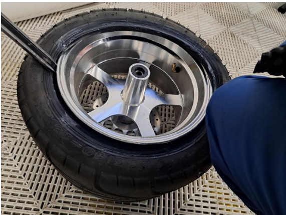
Vääntele rengas vanteelle toiseltakin puolelta.
