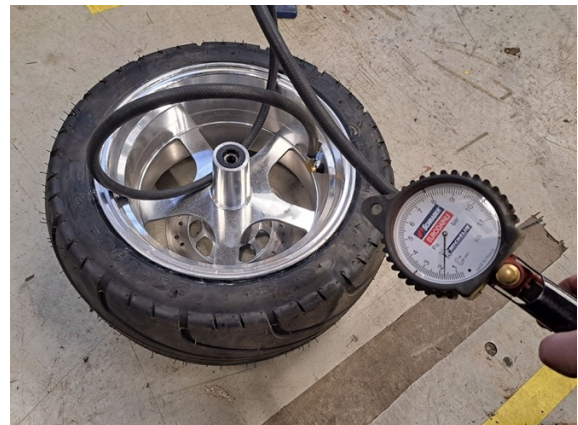
Täytä rengas ilman venttiilin sielua lievään ylipaineeseen, että rengas asettuu hyvin vanteelle.
