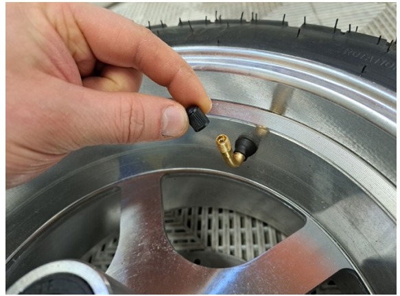
Laita venttiin hattu paikoilleen.
