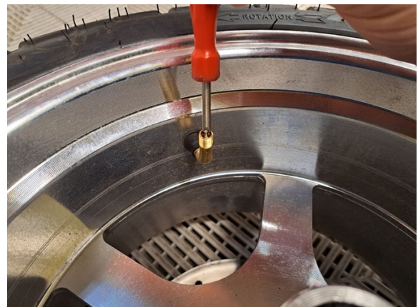
Kiristä venttiilin sielu. (venttiilityökalu).
