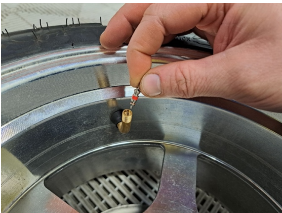
Laita venttiilin sielu venttiliin.
