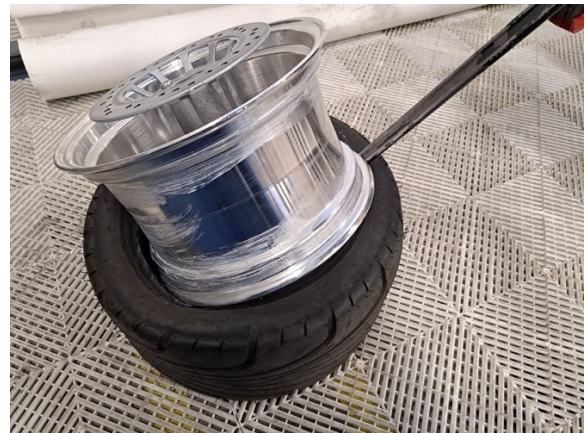
Laita vanne renkaan päälle niin, että se on puoliksi renkaan sisällä ja vääntele rengas rengasraudalla vanteen päälle.
