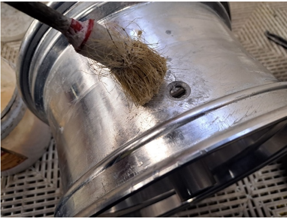
Levitä vanteen venttiin reikään rengasrasvaa.
