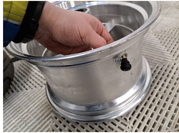
Laita uusi venttiili vanteeseen.
